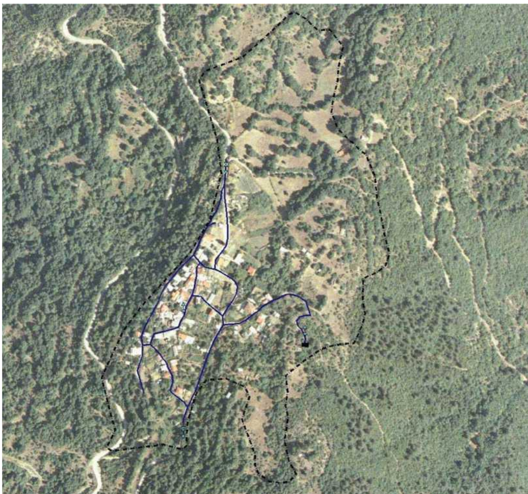
Σχήμα 3.1: Απόσπασμα ορθοφωτοχάρτη από ΚΤΗΜΑΤΟΛΟΓΙΟ Α.Ε, όπου με μπλε χρώμα εμφανίζεται η προτεινόμενη χάραξη, με μαύρο το όριο του οικισμού και παρουσιάζονται επίσης οι θέσεις των διατάξεων εκκένωσης και αερεξαγωγών που προτείνονται. (το σχήμα είναι άνευ κλίμακας).
