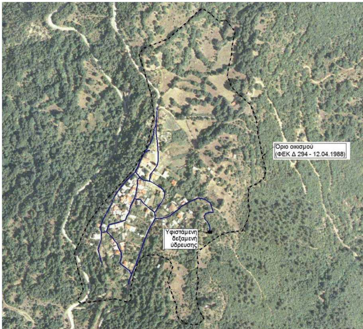
Σχήμα 2.1: Απόσπασμα ορθοφωτοχάρτη από ΚΤΗΜΑΤΟΛΟΓΙΟ Α.Ε, όπου εμφανίζεται η θέση της υφιστάμενης δεξαμενής ύδρευσης και το εγκεκριμένο όριο του οικισμού Εξοχής. (το σχήμα είναι άνευ κλίμακας).
